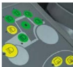
■ Le luci si regolano e impostano facilmente grazie alla loro semplice configurazione. Con il sistema ad un unico bottone, è possibile ruotare tutte le luci di lavoro contemporaneamente premendo un comando sulla tastiera.
