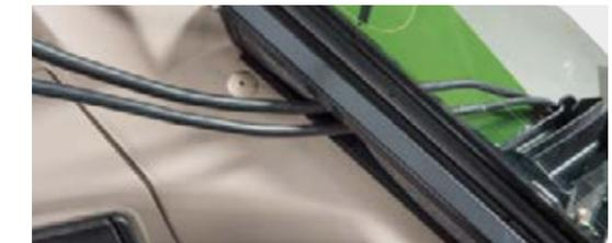
■ Fendt offre una soluzione intelligente per i cavi che dal retro del trattore passano in cabina. I cavi possono essere inseriti senza problemi nel passante, indipendentemente dalla loro sezione. Il finestrino posteriore può essere chiuso in modo da tenere lontano sporco e rumore.
