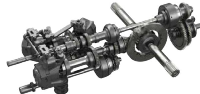
Il cambio Fendt Vario è una trasmissione idromeccanica con ripartizione della potenza. Con l'aumentare della velocità aumenta la percentuale di potenza trasmessa meccanicamente tramite il riduttore epicicloidale. Gli idrostati possono essere spostati di 45 gradi e hanno un'elevata pressione operativa massima di 550 bar che garantisce un'eccezionale efficienza.
