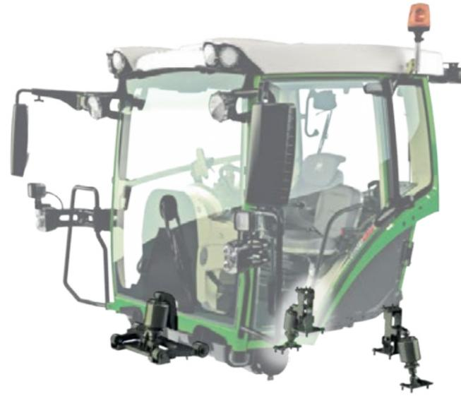
■ La sospensione della cabina su 3 punti con elementi pneumatici consente di ridurre al minimo le vibrazioni interne. La notevole differenza d'altezza e la distanza tra gli elementi della sospensione della cabina X5 impediscono inoltre fenomeni di beccheggio per un comfort di guida di altissimo livello.
