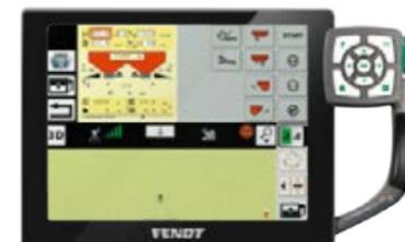
Variotronic™ Implement Control (ISOBUS) è perfettamente integrato nel terminale Vario da 7" e da 10,4". L'attrezzo viene controllato con il terminale e il joystick e non è richiesto un terminale supplementare.
