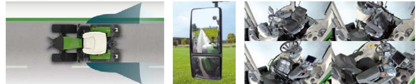
Per ampliare ulteriormente la gamma di applicazioni, Fendt offre un valido posto di guida reversibile. In alcune operazioni il sedile di guida può essere ruotato di 180° insieme al volante, al bracciolo multifunzione e a tutti gli elementi di comando.
