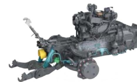
Il sollevatore anteriore del Fendt 900 Vario è dotato di un sistema di modulazione della pressione opzionale che consente di trasferire il peso dell'attrezzo al trattore. Questo è particolarmente vantaggioso quando si lavora con attrezzi di manutenzione in inverno o con tosaerba anteriori, in quanto riduce il carico sull'attrezzo e aumenta la sterzabilità. La limitazione di pressione può essere regolata dal terminale Vario.
