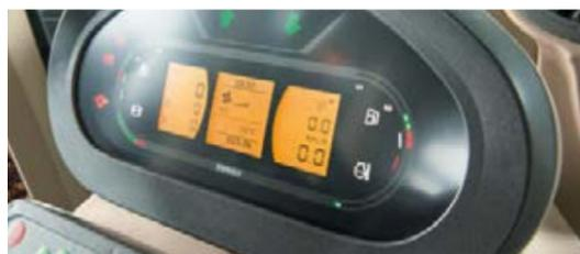
■ Le luci interne sono progettate per illuminare in modo perfetto le zone principali su cui si sta lavorando. Sia che sia giorno o notte, gli elementi operativi principali sono piacevolmente retroilluminati. L'intensità dell'illuminazione è controllata automaticamente da un sensore ottico in funzione delle condizioni di luce.
