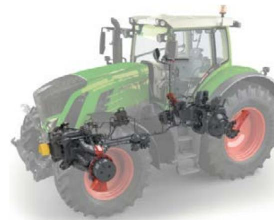
L'impianto di regolazione della pressione di gonfiaggio dei pneumatici integrato VarioGrip adatta la pressione dei pneumatici nel minor tempo possibile, perfino durante la marcia. Ciò avviene tramite il distributore rotante interno, progettato per durare per l'intero ciclo di vita del trattore. L'aria viene alimentata da un doppio compressore raffreddato ad acqua nonché dal sistema di valvole proprio del veicolo.
